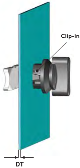
Door Thickness : 0.8 mm - 1.2 mm
